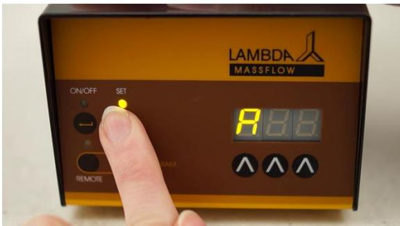
**Figura 3.4-1** Mantenga presionado el botón **SET** mientras conecta nuevamente el cable de la fuente de energía al equipo. La pantalla del panel frontal se iluminará y mostrará el mensaje **"A00"**.
