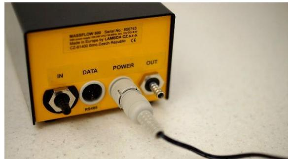
**Figura 1.1-4** Conecte el cable de la conexión universal de la fuente de energía dentro del enchufe “POWER” (12 V) en la parte trasera del controlador de flujo de gases y caudalímetro y asegúrelo.
