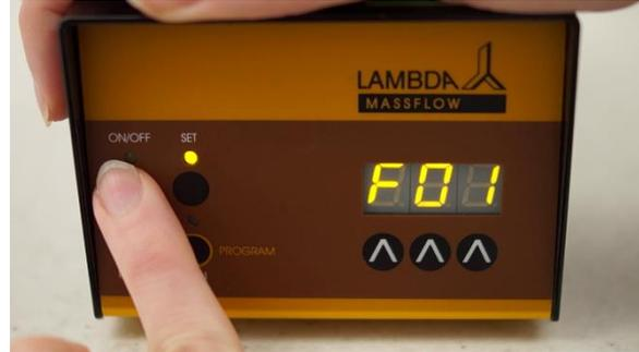
**Figura 2-2** Presione el botón **ON/OFF**. El mensaje **"F01"** aparecerá por 1 segundo en la pantalla seguido por el valor de velocidad de flujo o caudal del primer paso, el cual ha sido almacenado en la memoria.
