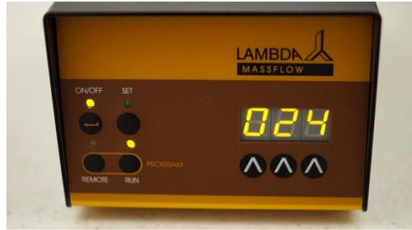
**Figura 2.1-2** De no ser así, la lectura inicial 000 (o 0.00 para el MASSFLOW 5000) vista al inicio se incrementará gradualmente hasta que se alcance la velocidad de flujo o caudal programada. Esta operación toma alrededor de 15 segundos en dependencia de la velocidad de flujo o caudal seleccionado.
