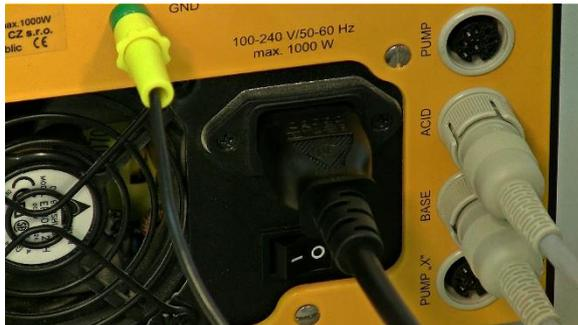
**Figura 1.1-1** Un extremo del cable de 8 polos debe ser conectado en enchufe “PUMP” en la parte trasera de la unidad de control de biorreactor-fermentador LAMBDA MINIFOR.
