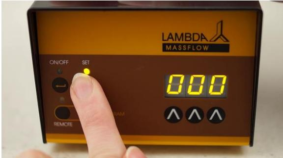
**Figura 1.3-1** Presione el botón **SET**. El LED correspondiente se encenderá y en la pantalla aparecerá el valor prefijado de velocidad de flujo o caudal.
