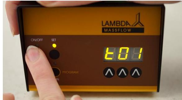
**Figura 2-4** Presione el botón **ON/OFF** nuevamente. El mensaje **"t01"** aparecerá en la pantalla indicando que el período de tiempo del primer paso debe ser programado. La pantalla mostrará el período de tiempo memorizado en la programación anterior.
