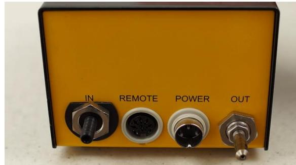
**Figura 1.1-2** El otro extremo debe ser conectado en el enchufe REMOTE en la parte trasera del controlador de flujo de gases y caudalímetro MASSFLOW.
