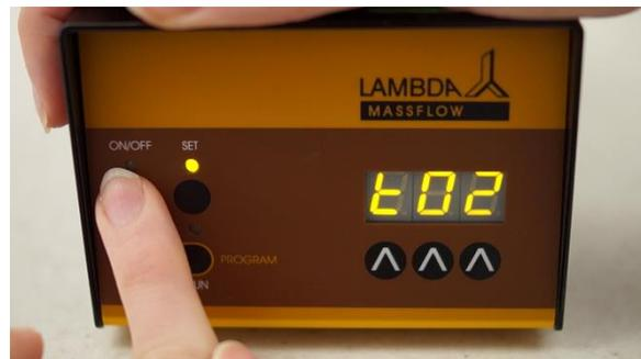
**Figura 2-8** Presione el botón **ON/OFF**. Aparecerá por breves instantes el mensaje **"t02"** en la pantalla seguido por el valor de la duración del paso de la programación previa memorizada.
