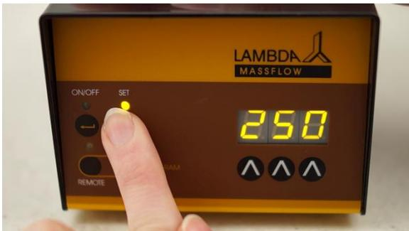
**Figura 1.3-3** Presione el botón **SET** nuevamente. El LED se apagará y la pantalla muestra el valor real de velocidad de flujo o caudal. Debe indicar 0.0 L/min.
