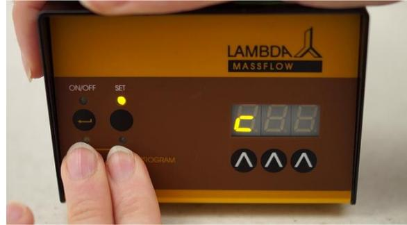
**Figura 2-12** Presione los botones **REMOTE** y **RUN** simultáneamente para ver el mensaje **"C"** en la pantalla. Esta función permite repetir el programa de una vez (si Ud selecciona **"01"**) hasta 255 veces (si Ud selecciona **"255"**).
