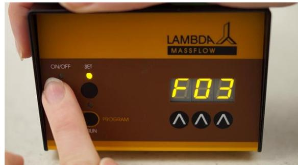
**Figura 2-10** Después de haber introducido el tiempo del último paso, presione el botón **ON/OFF**. Por ejemplo: **"F03"**.
