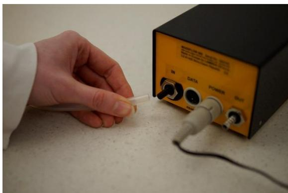
**Figura 1.2-1** Conecte el tubo o manguera de gases (de diámetro interno de 5.5 a 6 mm) a la boquilla para gas **IN** y asegúrela en el lugar con pinzas apropiadas.
