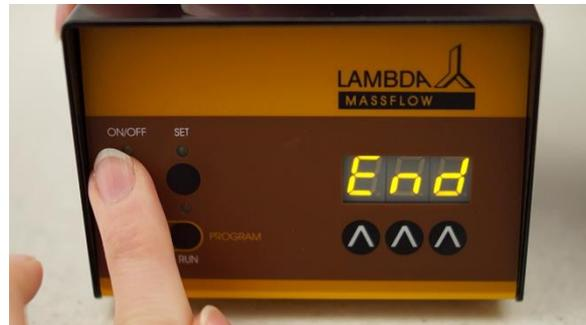
**Figura 2-14** Presione el botón **ON/OFF** para confirmar el ciclo seleccionado. El mensaje **"End"** aparecerá en la pantalla y el instrumento estará listo para su uso.
