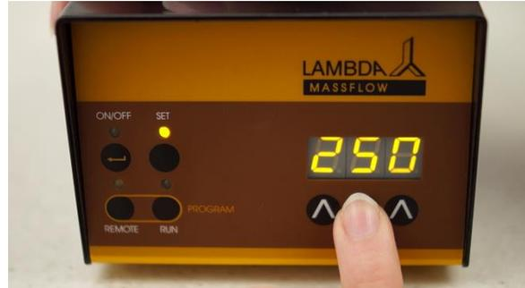
**Figura 1.3-2** Ajuste o introduzca el valor deseado de velocidad de flujo con los botones de flechas  $\wedge \wedge \wedge$  debajo de la pantalla LED.
