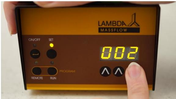
**Figura 2-13** Si Ud desea repetir el mismo programa dos veces, incremente el número de ciclos hasta **"002"** presionando los botones de flechas en la pantalla **^ ^ ^**.
