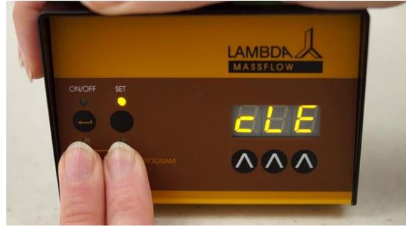
**Figura 2.3-2** Presione de forma continua y simultánea los botones **REMOTE** y **RUN** incluso después de la indicación de "PGM" y finalmente se mostrará el mensaje "cLE". Esto indica que el programa existente fue borrado de la memoria del equipo.
