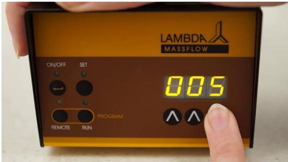
**Figura 2-5** Seleccione la duración de la primera velocidad de flujo o caudal (por ejemplo: 005 = cinco minutos).
