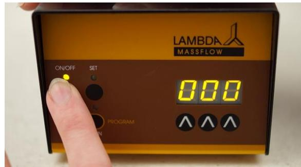
**Figura 1.3-4** Presione el botón **ON/OFF**. Después de cerca de 10 segundos (cerca de 30 segundos para velocidades de flujo menores), la velocidad de flujo o caudal alcanzará gradualmente el valor prefijado.
