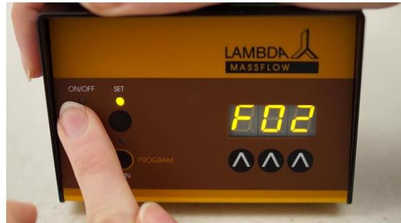
**Figura 2-6** Presione el botón **ON/OFF**. A continuación aparecerá el mensaje **"F02"** en la pantalla y después de 1 segundo, se mostrará el valor de caudal o flujo para este paso que fue memorizado con anterioridad.
