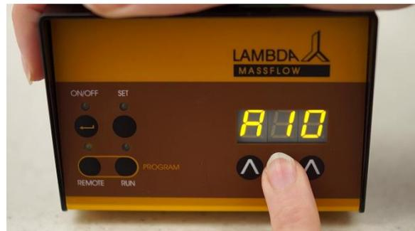
**Figura 3.4-2** Libere el botón **SET**. Seleccione la dirección desde 0 hasta 99 y presione el botón **ON/OFF** para salvar el valor introducido.
