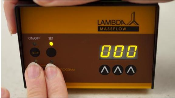
**Figura 2-11** Cuando la velocidad de flujo o caudal (000) del próximo paso que no será programado aparezca en la pantalla. No cambie la velocidad de flujo o caudal (000).
