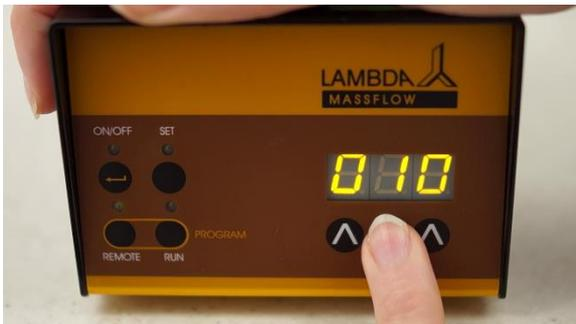
**Figura 2-9** Seleccione el Nuevo tiempo de duración de la segunda velocidad de flujo o caudal introducido.
