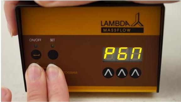
**Figura 2.3-1** Presione los botones **RUN** y **REMOTE** simultáneamente. El mensaje "PGM" aparecerá en la pantalla.
