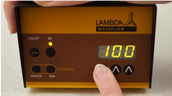
**Figura 2-3** Presione los botones de flechas **▲ ▲ ▲** bajo la pantalla para seleccionar el valor deseado de velocidad de flujo del primer paso (por ejemplo: 100 mL/min para MASSFLOW 500 o 0.1 L/min para MASSFLOW 5000).
