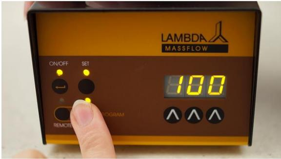
**Figura 2.1-1** El programa se comienza presionando el botón **RUN** y el LED correspondiente se encenderá. La velocidad de flujo o caudal del primer paso aparecerá en la pantalla si se activa el botón **SET**.
