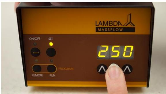
**Figura 2-7** Seleccione el valor de velocidad de flujo o caudal del Segundo paso presionando los botones de flechas  $\wedge \wedge$  bajo la pantalla.
