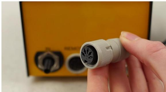
**Figura 1.1-3** Conector de 5 polos del cable de la conexión universal de la fuente de energía (100-240 V AC/50-60 Hz, 12 VDC, 24 W).
